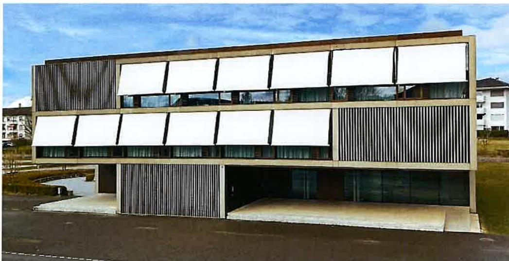
**Stores :** Comme la salle de gym, le collège est équipé de stores en toile sur les 4 façades et avec l'usure, les toiles se déchirent malgré que le bâtiment soit équipé d'un système de sécurité qui les remonte en cas de vent.
